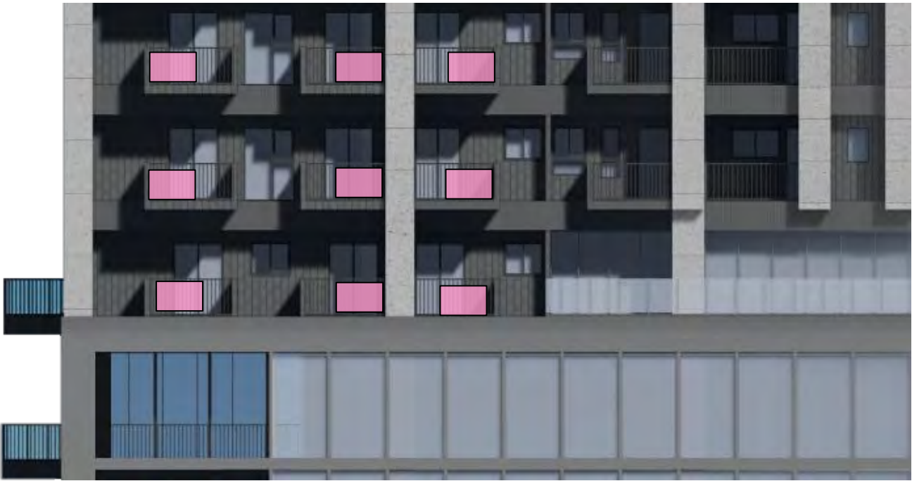
圖12-13 南向立面空調設備位置立面示意圖
