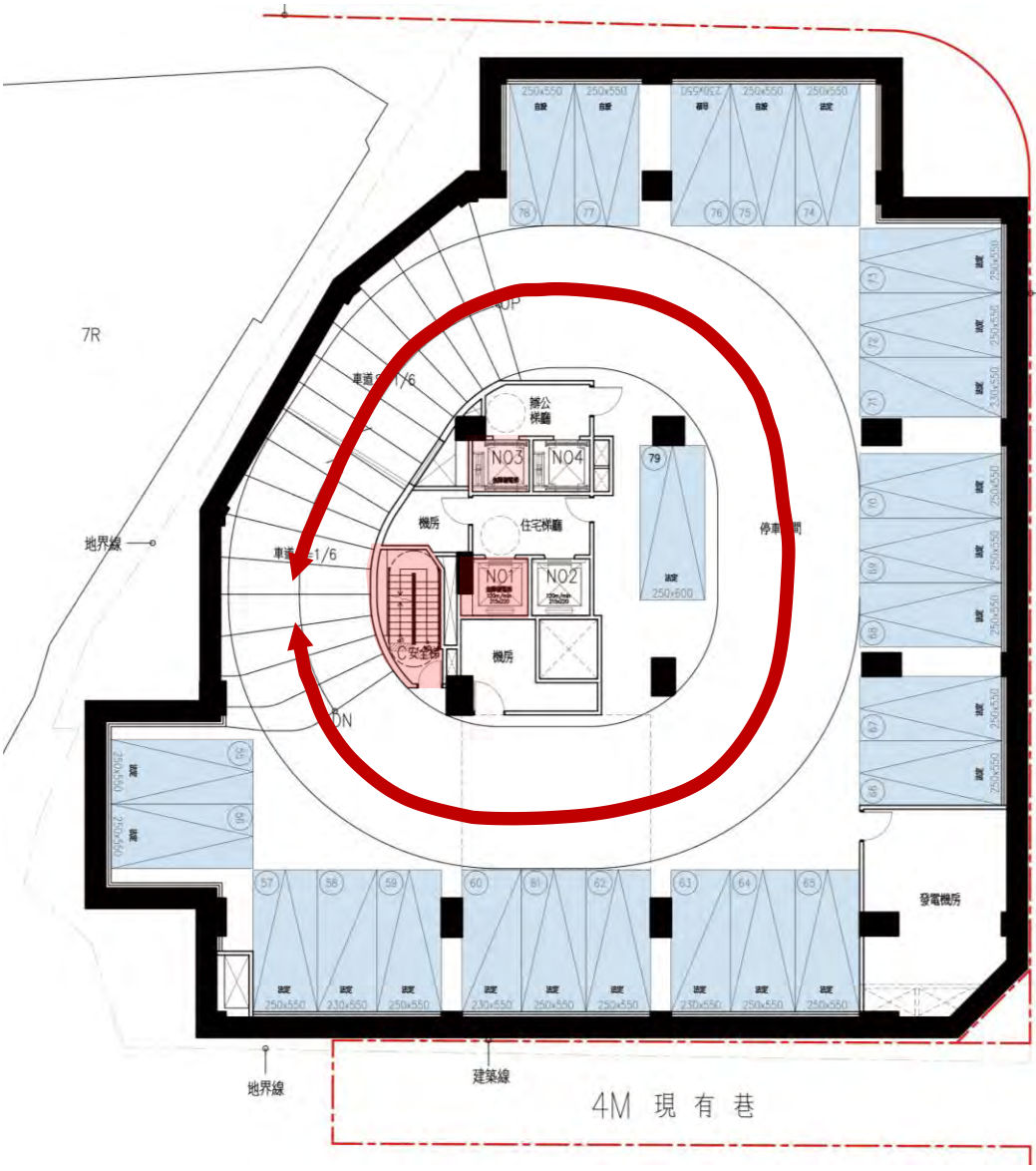
圖12-6 地下貳層汽機車停車及動線計畫圖
