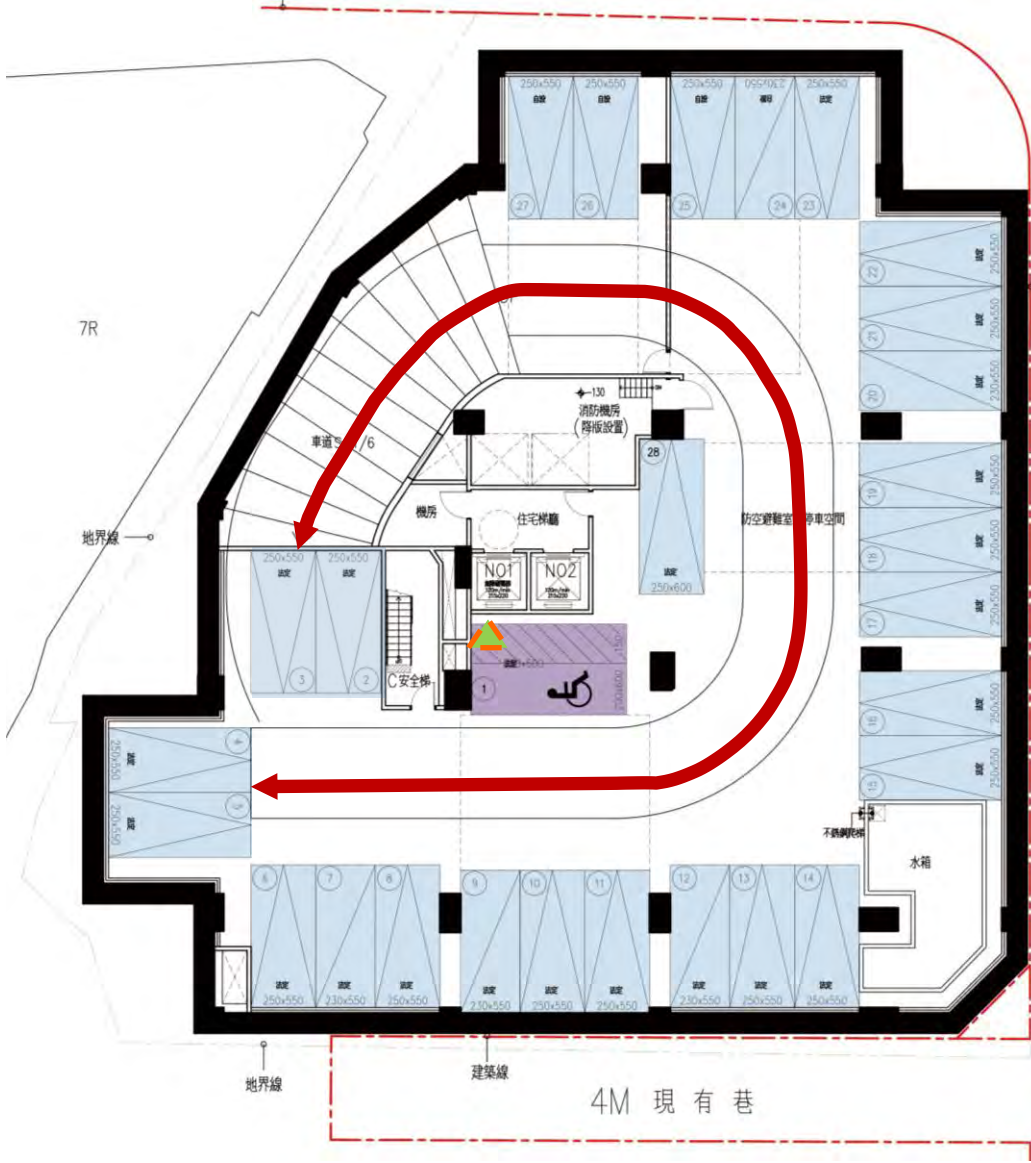
圖12-8 地下肆層汽機車停車及動線計畫圖
