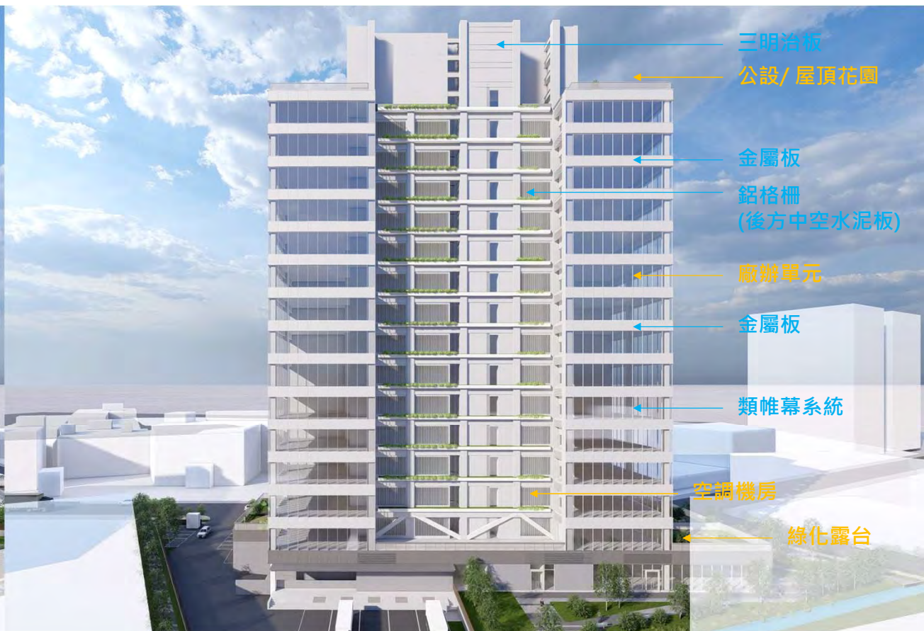
South Elevation 南向立面
